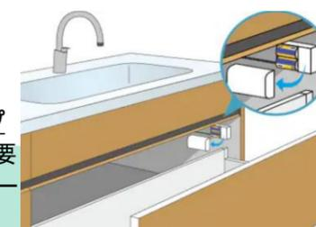
浄水センサーと湯水センサーの2つのセンサーを使い分けてカンタンに吐水・止水ができます。
